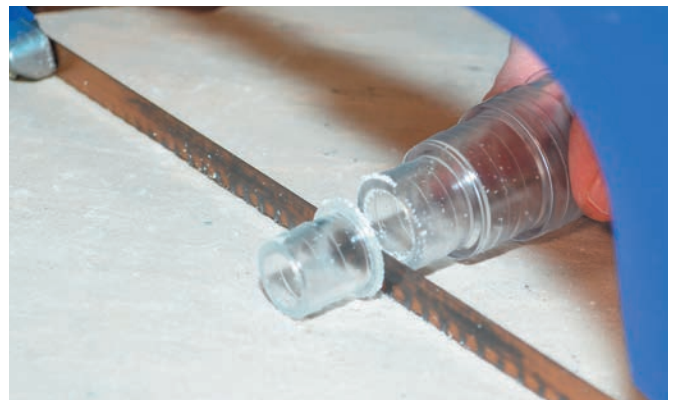
Teil vom Schlauchanschluss mit Eisensäge entfernen
